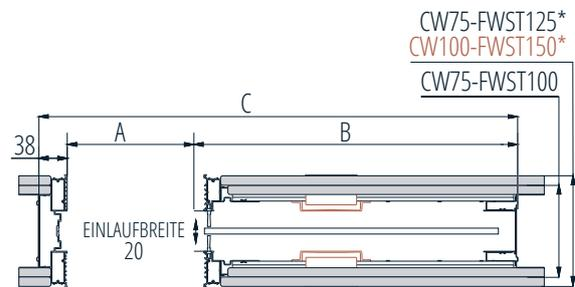
FWST = Fertigwandstärke | CW = Profilstärke | \* Doppelbeplankung | \* bei Kabelkanal vormontiert für FWST 150
