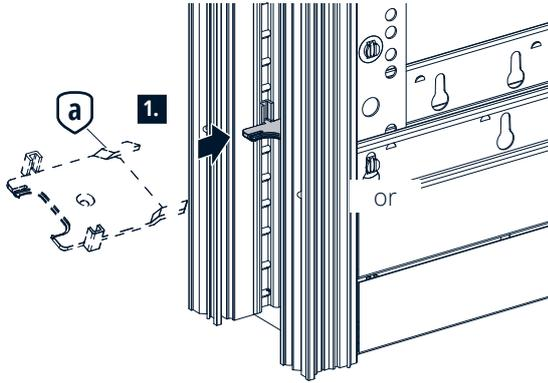
**i** Wenn **keine** Fußbodenheizung verbaut wurde, darf die Bodenführung gegebenenfalls auch verschraubt werden.
