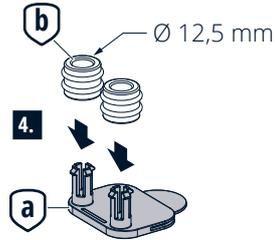
**i** Die Bodenführung kann auch erst nach dem Einhängen des Türblatts eingeklipst werden.
