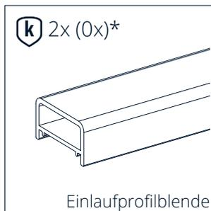
\* Die Einlaufprofilblenden sind bereits vormontiert wenn Beschlag und Einlaufelement zusammen bestellt werden.
