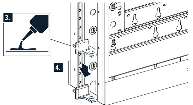
**i** Wenn **keine** Fußbodenheizung verbaut wurde, darf die Bodenführung gegebenenfalls auch verschraubt werden.
