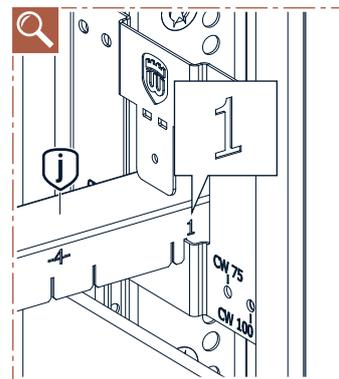
**i** Bei Sonderbreiten oder Glasschiebetüren Bauteil „j“ von unten an das Winkelblech schrauben!
