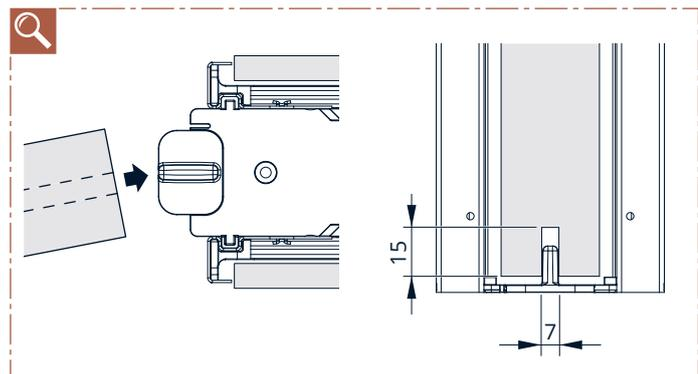
**!** Falls Sie die Bodenführung erst nachträglich montieren möchten, schützen Sie die beiden seitlichen Flächen des Türblatts mit Kartonaugen gegen Stöße und Kratzer beim Einhängen.
