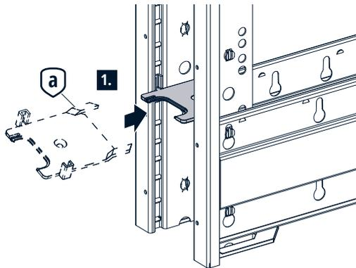
**i** Wenn **keine** Fußbodenheizung verbaut wurde, darf die Bodenführung auch verschraubt werden.
