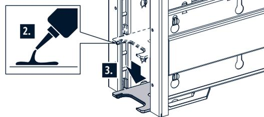
**i** Bei vollständig durchgefrästen Führungsnuten kann die Bodenführung auch erst nach dem Einhängen des Türblatts eingeklipst werden.
