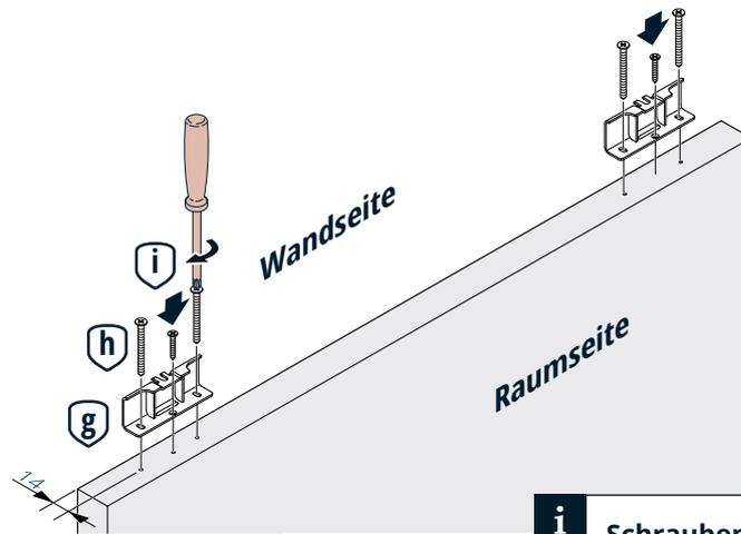
**i** Schraubenlöcher mit einem 3 mm Bohrer 45 mm tief vorbohren!
