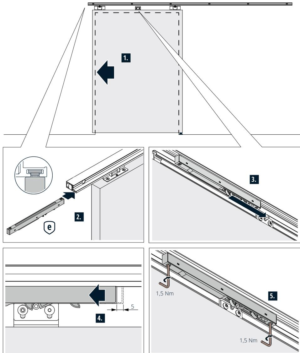
**i** Damit die Dämpfer nicht unter Dauerspannung stehen, müssen diese 5 mm aus der Endlage geschoben werden. Die Lebensdauer der Dämpfer wird verlängert.
