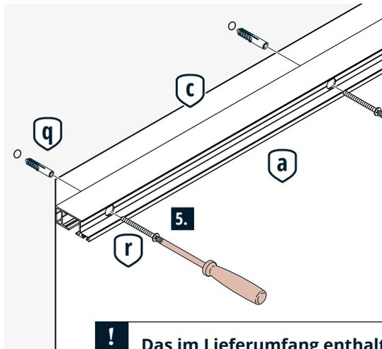
**!** Das im Lieferumfang enthaltene Befestigungsmaterial ist nur für Vollstein Mauerwerk und Vollstein Leichtbeton geeignet. Bei anderen Untergründen ist geeignetes Befestigungsmaterial bauseits zu stellen.
