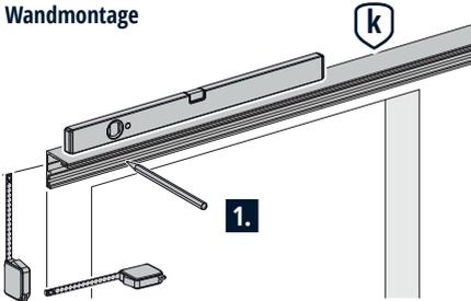
**!** Das Mauerwerk ist zu prüfen. Geeignetes Befestigungsmaterial ist bauseits zu stellen!
