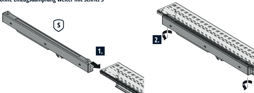
Montageoption: Befestigung der Einzugsdämpfer von unten
