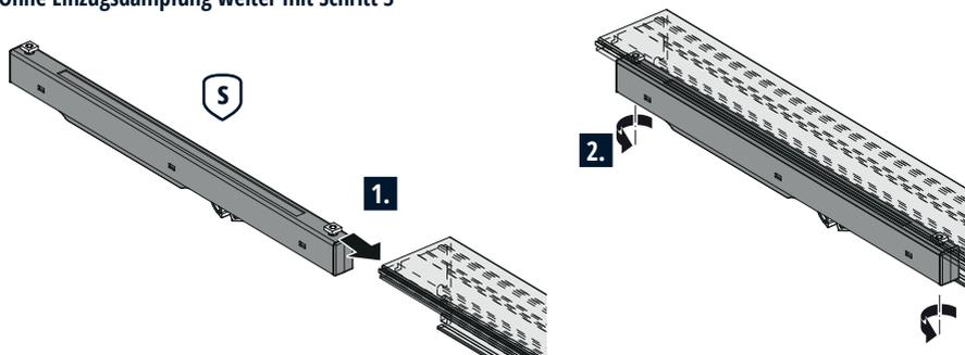
Montageoption: Befestigung der Einzugsdämpfer von unten
