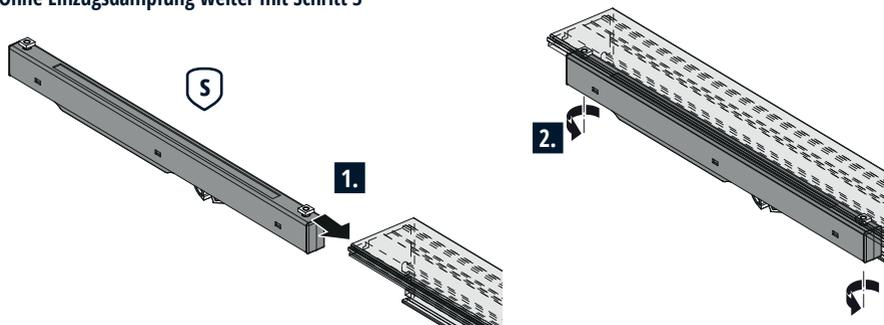
Anordnung der Einzugsdämpfung in der Laufschiene
