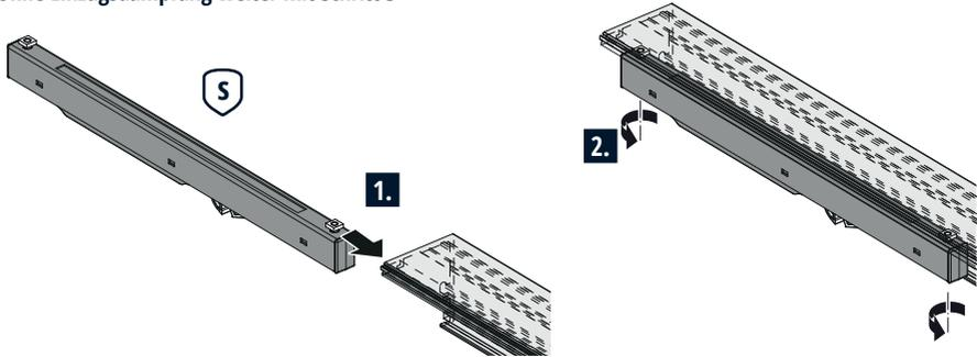
Anordnung der Einzugsdämpfung in der Laufschiene
