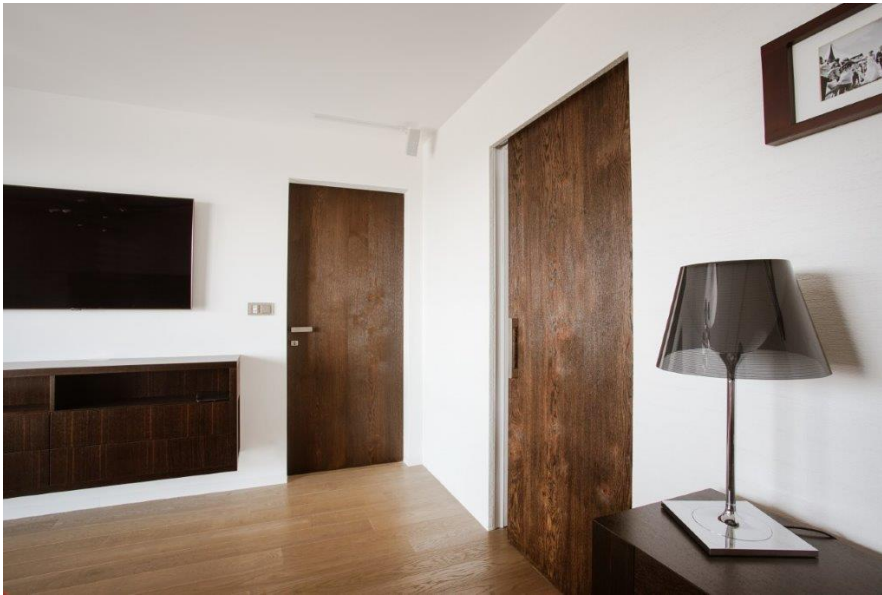
Wingburg_Belport_2: Das Schiebetürsystem Belport ist komplett in der Wand verbaut, sodass nur das Türblatt sichtbar ist.
