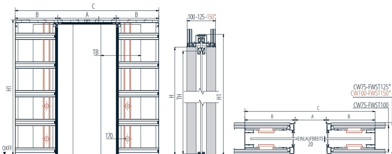
FWST = Fertigwandstärke | CW = Profilstärke | \* Doppelbeplankung | \* bei Kabelkanal vormontiert für FWST 150
