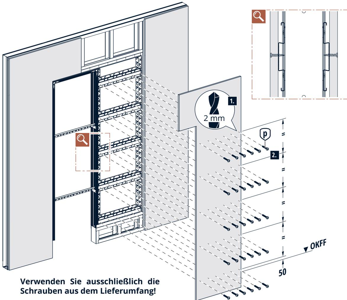
Verwenden Sie ausschließlich die Schrauben aus dem Lieferumfang!
