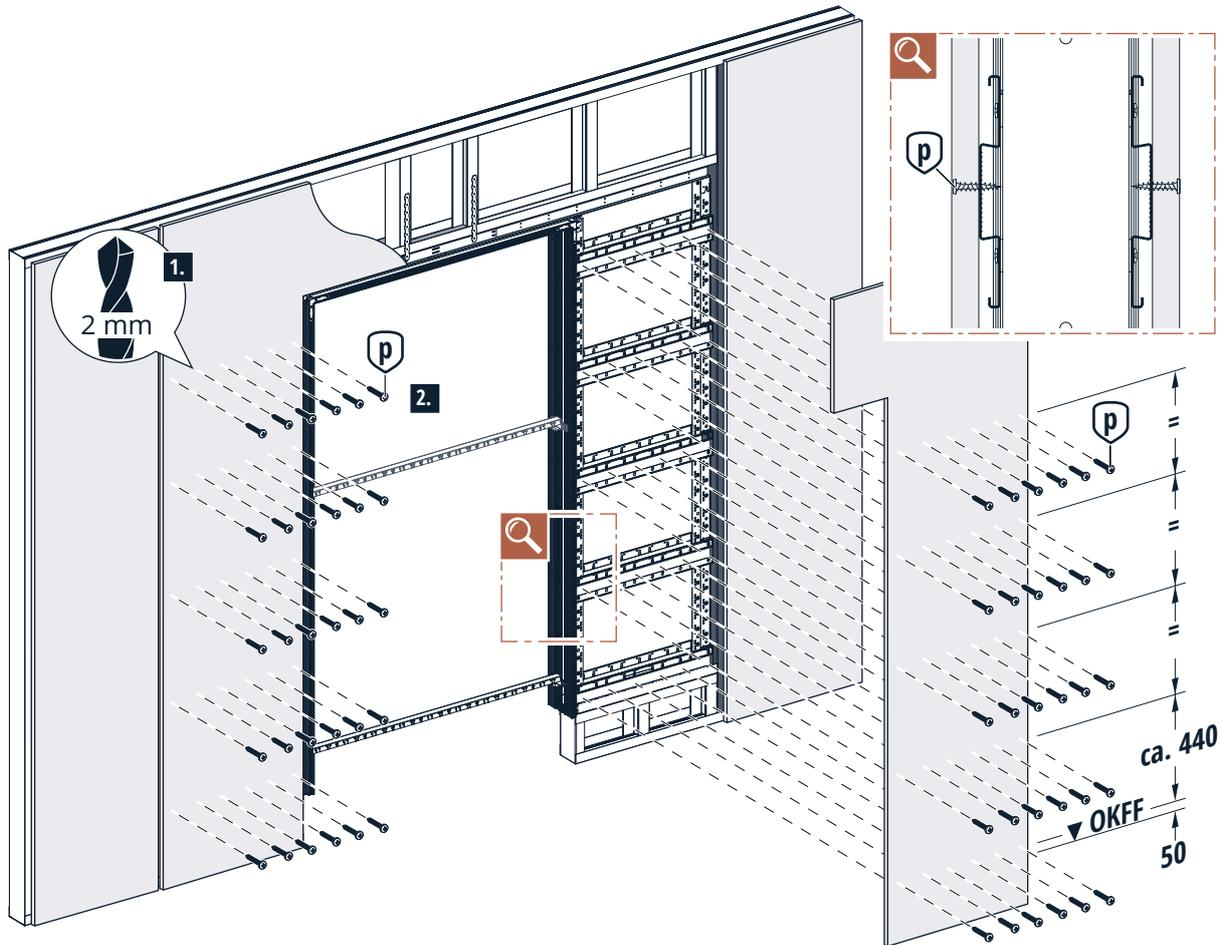
**Verwenden Sie ausschließlich die Schrauben aus dem Lieferumfang!**
