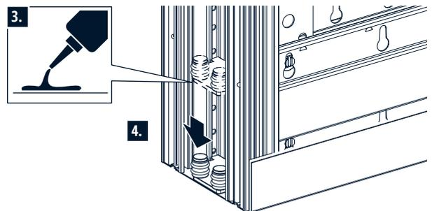
**i** Wenn **keine** Fußbodenheizung verbaut wurde, darf die Bodenführung gegebenenfalls auch verschraubt werden.
