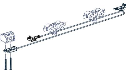
**ZUZIEHAUTOMATIK** Die Zuziehautomatik sorgt dafür, dass die geöffnete Schiebetür nach circa 11 Sekunden automatisch ins Schloss fällt, und das unsichtbar. Das gelingt allein mit dem Energieaufwand der Türöffnung und bedarf keines Stromanschlusses.
