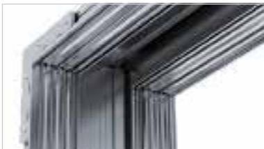
**Laibungsprofil** Die Beplankung wird bei der Montage bis an das Profil herangeführt. Die Profilkontur bildet beim Verspachteln eine kraftvolle Verbindung zwischen Gipskarton und Laibungsprofil und dient als Kantenschutz.
