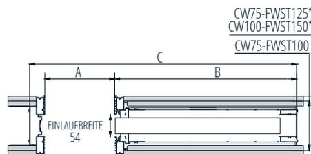
FWST = Fertigwandstärke | CW = Profilstärke | \* Doppelbeplankung
