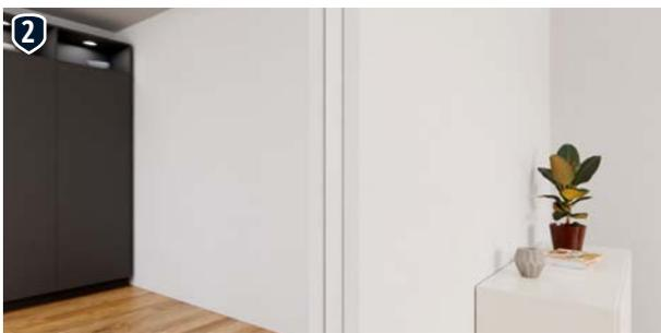
Die volle Durchgangsbreite kann genutzt werden, da das Türblatt bündig mit der Wand abschließt.
